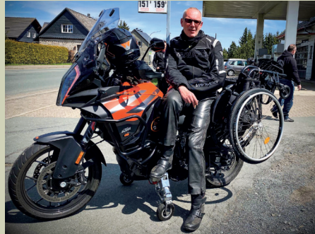
Holger Nadolny fährt eine durch »Landing Gear«, Fingerschaltung und Daumenbremse optimierte KTM 1290 Super Adventure S, den Falt-Rolli kann er seitlich mitnehmen.
