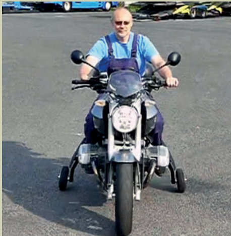
Holger Nadolny fährt eine durch »Landing Gear«, Fingerschaltung und Daumenbremse optimierte KTM 1290 Super Adventure S, den Falt-Rolli kann er seitlich mitnehmen.
